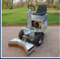
Aufsitzspaltenschieber mit Dieselmotor
