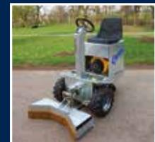
Aufsitzspaltenschieber mit Dieselmotor
